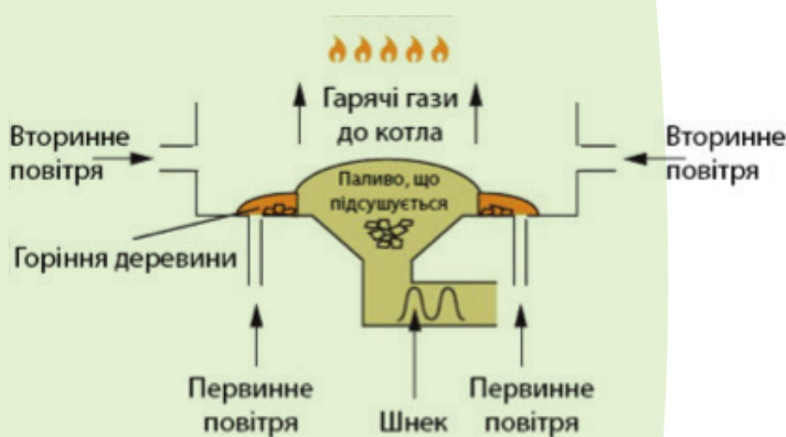
Рисунок 5. Котел з нижньою подачею палива [2]
