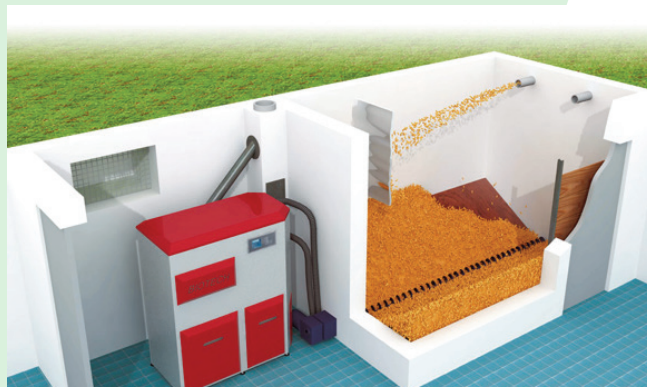
Рисунок 7. Приклад сучасної опалювальної системи на пелетах Biotech Energietechnik GmbH [4]
