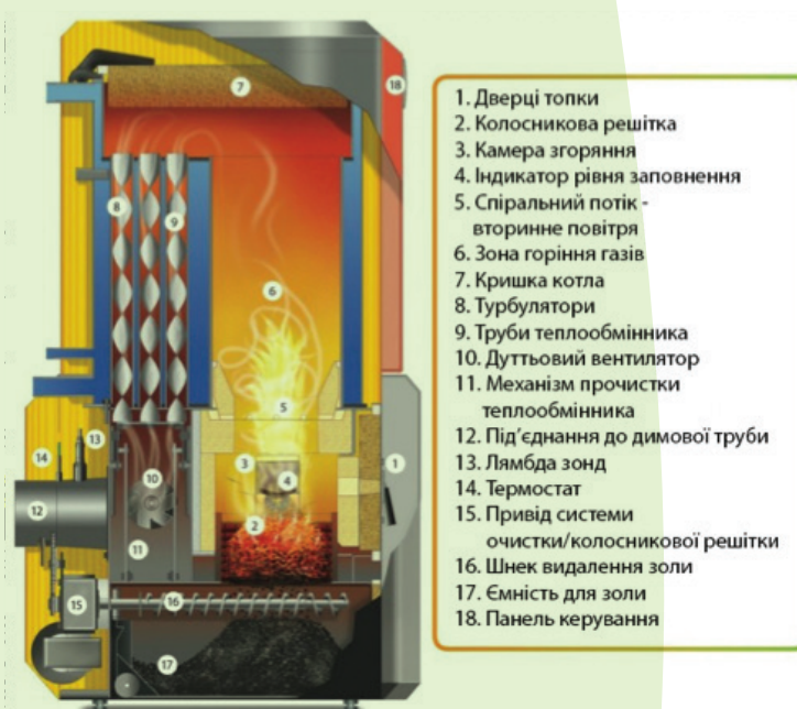
Рисунок 3. Сучасний котел на біомасі з вентилятором і лямбда датчиками (на прикладі котла Guntamatic Powerchip) [3]
