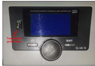
Твердотопливные отопительные котлы ЕКО – КWP оснащены микропроцессорным регулятором EL48 / В 100 zPID с непрерывным сигналом, использующим алгоритм регулирования PID, обеспечивая управление подачей топлива, дутьевым вентилятором, насосом отопительного контура (дополнительное оборудование), насосом горячей воды (дополнительное оборудование).
