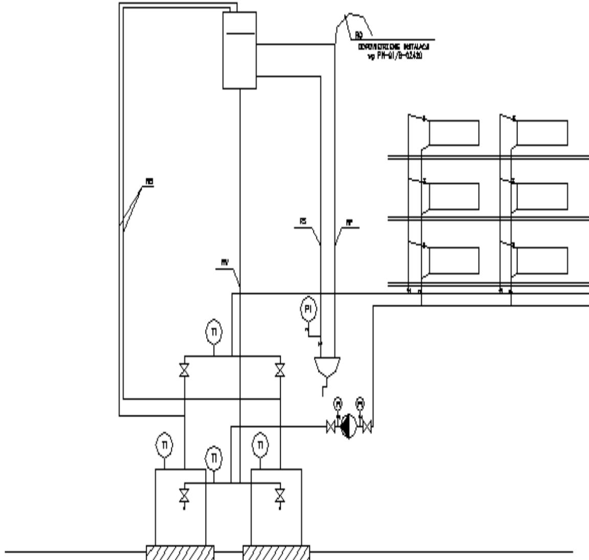
**Рисунок 3. Схема защиты системы водяного отопления, оснащенного двумя или более котлами, насос установлен на возврате (согласно PN-91/B-02413)**
